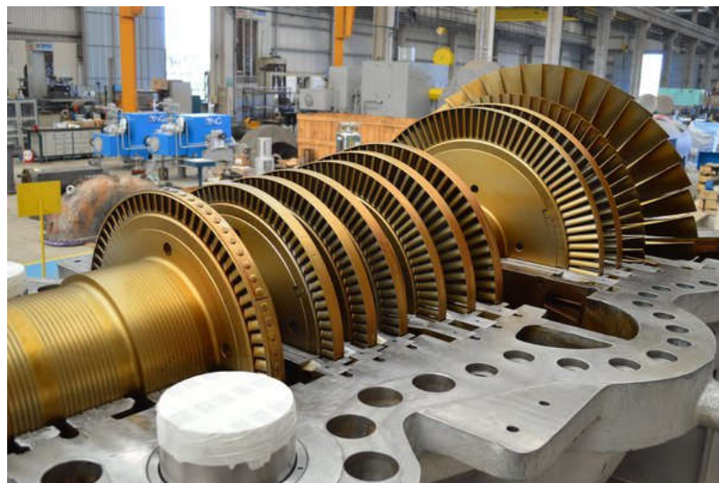
Fig. 4.2 : Turbine à vapeur
