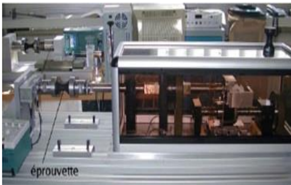
Figure I.18 : dispositif de traction-torsion du Centre des Matériaux.
