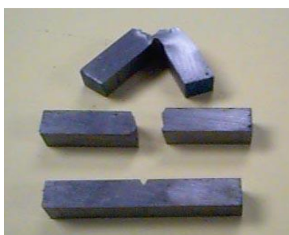
Figure I.16 : Exemple des éprouvettes après l'essai de résilience.
