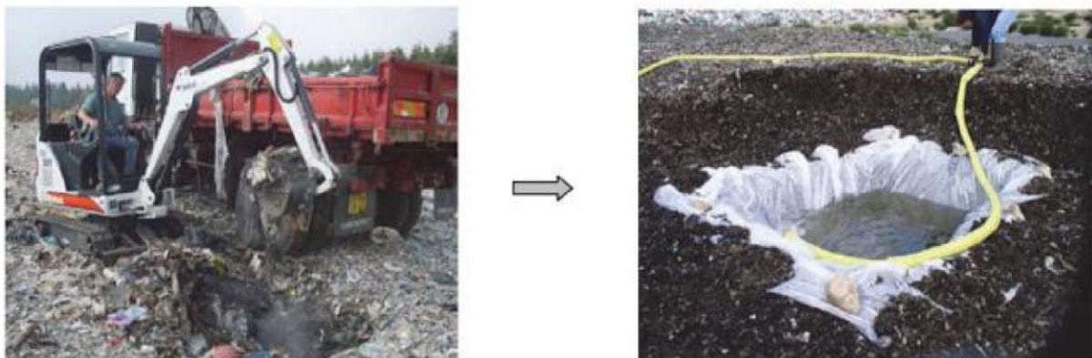
Figure 6.2 : Mesure de densité des déchets de surface. A gauche : excavation à la pelle. A droite : remplissage du puits excavé et étanché à l'aide d'une citerne d'eau, ADEME (2005).
