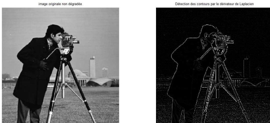
**figure-V-5** Détection des contours par filtre de Laplacien.
