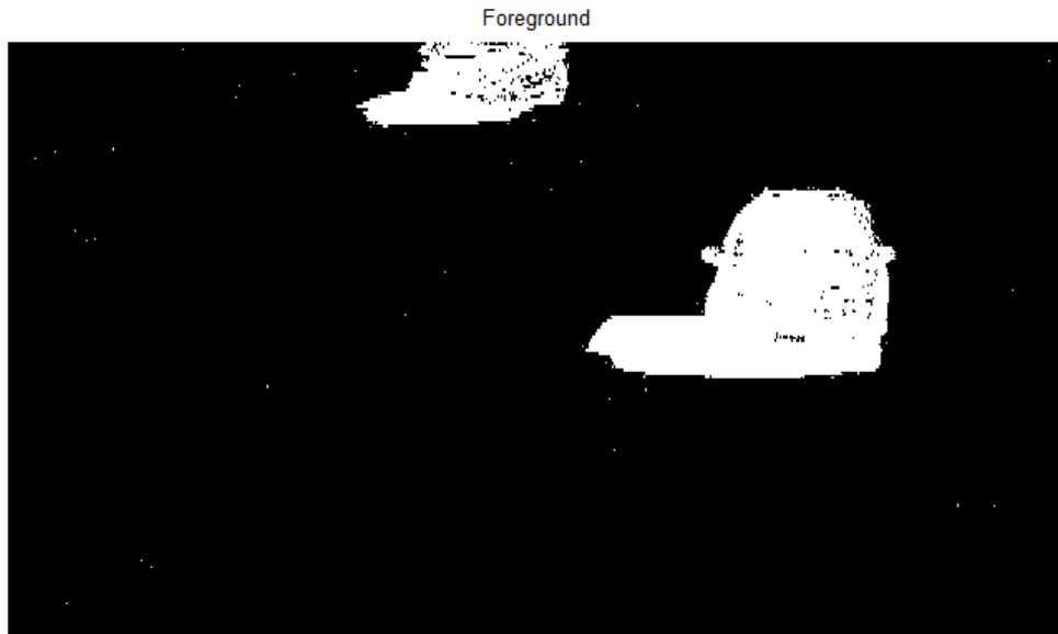
Figure-VIII-10 Soustraction entre trames de la vidéo éliminant l'arrière plan (objets fixes) de la vidéo.
