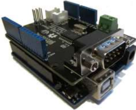
(a). can-bus shield enfiché sur carte Arduino UNO
