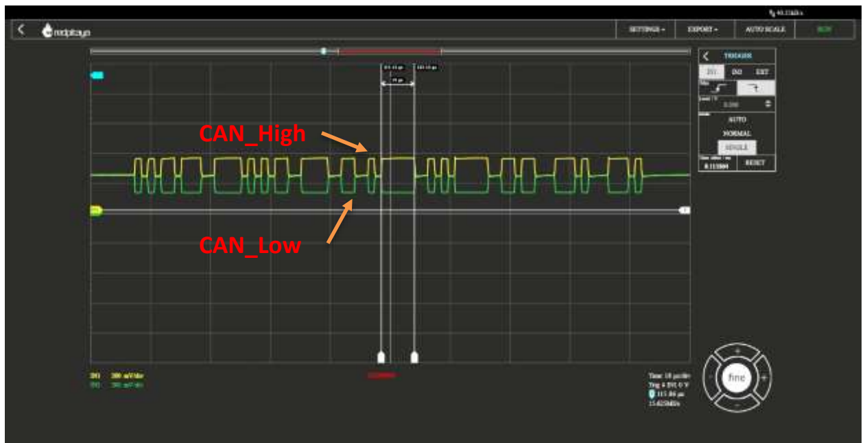
Figure 28 Tracé des lignes CAN_H et CAN_L sur oscilloscope RedPitaya 6
