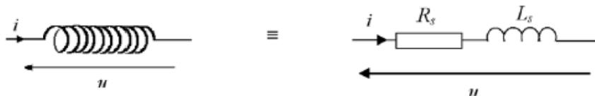
FIGURE 4.1 – Modèle série d'une bobine réelle.
