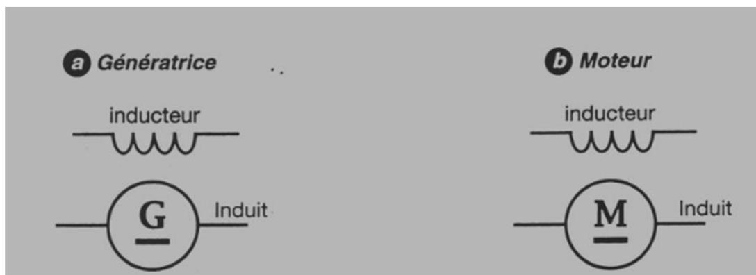
Figure 5 : symboles électrique d'une génératrice à courant continu (a) et d'un moteur à courant continu (b) , les lettres G et M signifient respectivement génératrice et moteur . Le trait horizontal sous la lettre décrit un courant continu.
