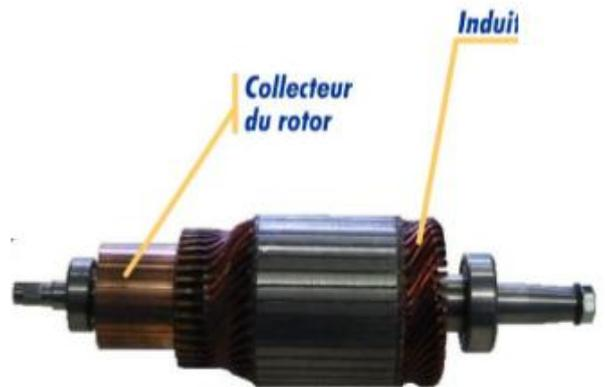
Figure 8 : induit complet d’une machine à courant continu
