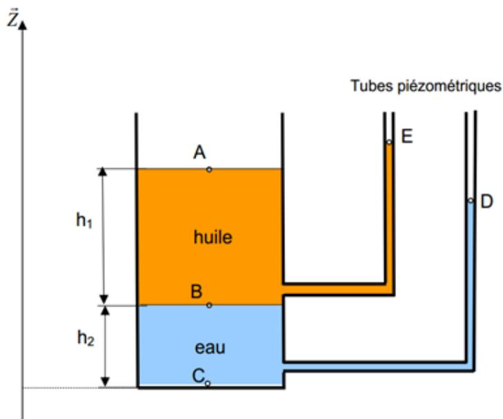
**Figure 2.13:** un réservoir ouvert, équipé de deux tubes piézométriques et rempli avec deux liquides non miscibles
