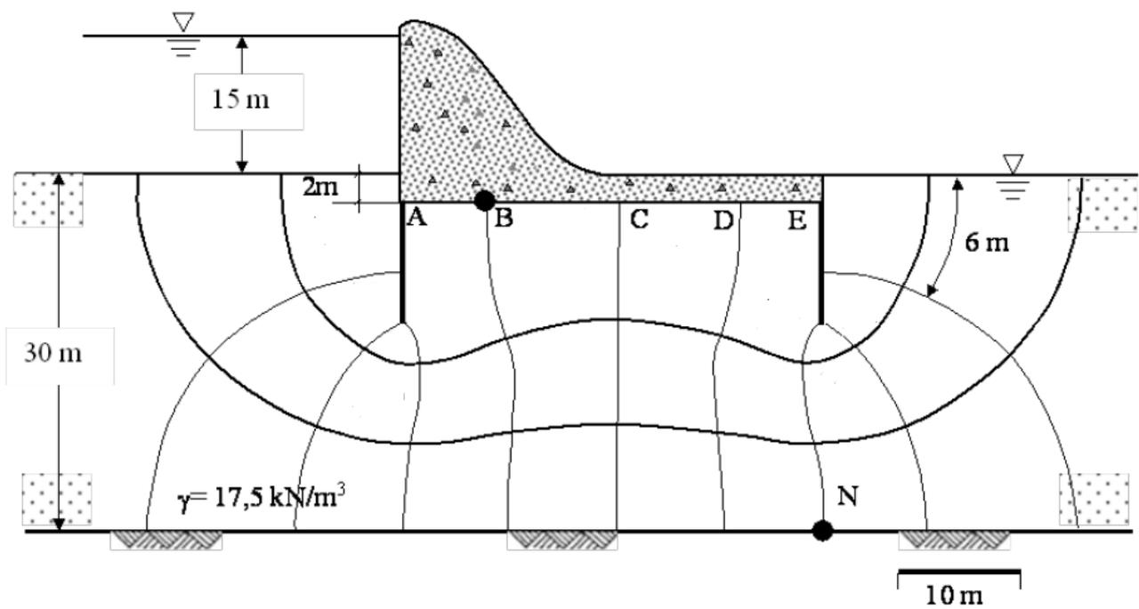
Figure 4.24: L'écoulement 2D au travers de la fondation d'un barrage poids
