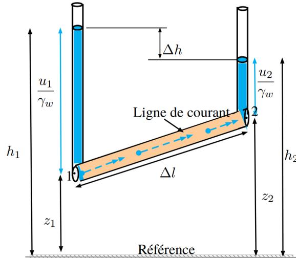
Figure 4.3: la Charge hydraulique totale  $h$  en termes de charge de position  $z$  et de charge piézoélectrique  $\frac{u}{\gamma_w}$
