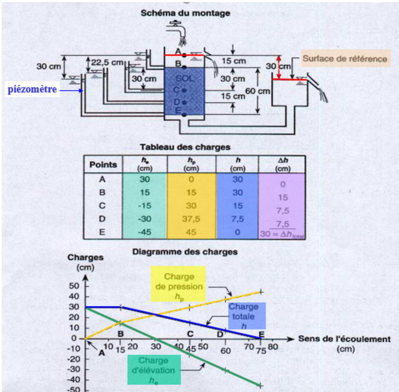
Figure 4.10: Exemple de calcul de la charge
