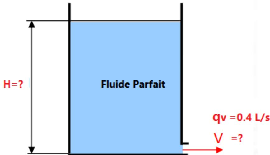
Figure 3.7: un réservoir avec un débit volumique  $q_v = 0,4 \text{ L/s}$
