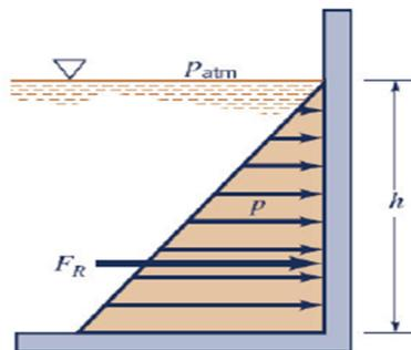
**Figure 2.8:** La pression le long d'une paroi verticale
