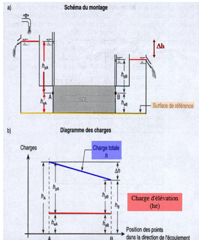
Figure 4.9: schéma de diagramme des charges hydrauliques
