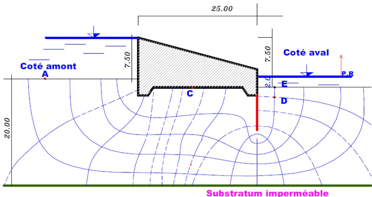
Figure 4.25: Le réseau d'écoulement à mailles carrées dans la fondation d'un barrage
