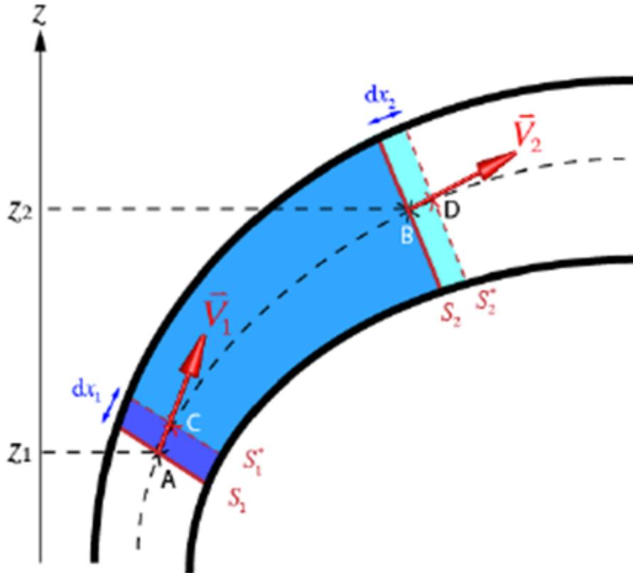
Figure 3.5: La conservation de l'énergie mécanique lors de l'écoulement d'un fluide parfait
