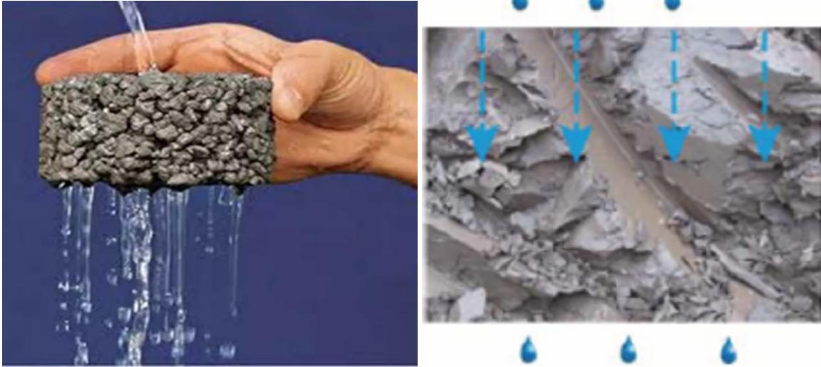
Figure 4.2: La perméabilité dans les matériaux poreux et les argiles
