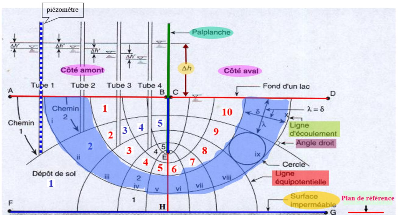
Figure 4.19: tubes de courant dans un réseaux d'écoulement bidimensionnel
