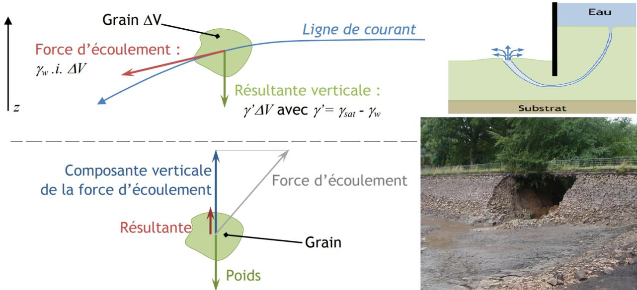
Figure 4.16: Les mécanismes de l'érosion interne
