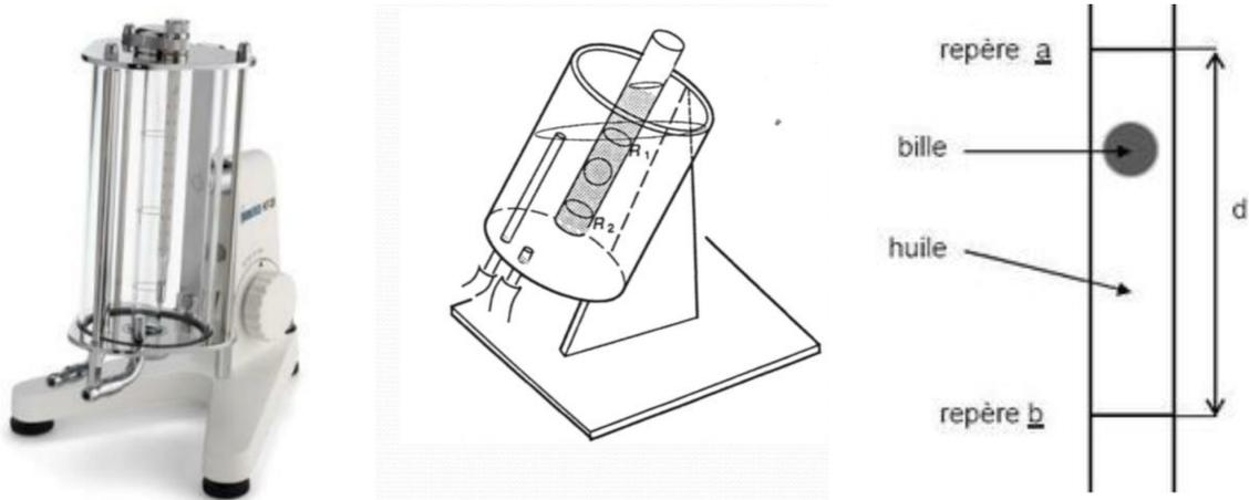
**Figure 1.14:** La méthode de la boule de chute
