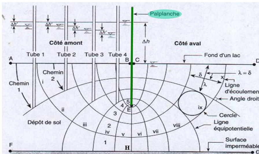
Figure 4.17: Réseaux d'écoulement bidimensionnel (à main levée)
