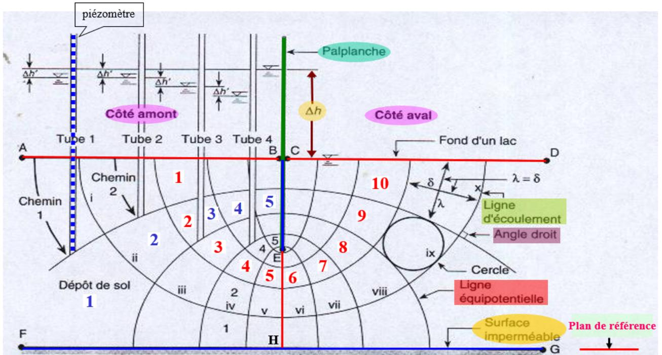
Figure 4.18: Lignes de courant et lignes équipotentielle dans un réseaux d'écoulement
