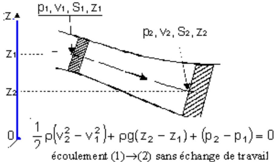
**Figure 2.7:** Relation de Bernoulli ( dans le cas de l'écoulement permanent d'un fluide parfait)
