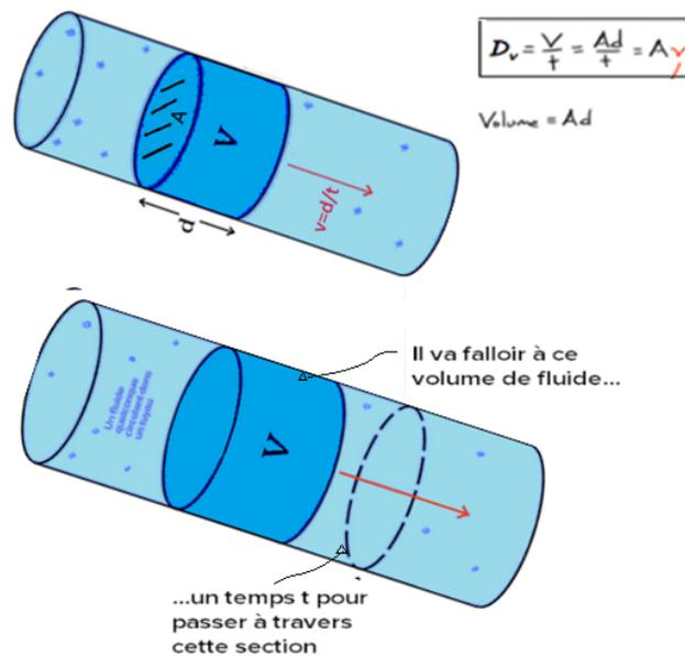
**Figure 3.1:** Débit volumique (Dv) d'un fluide et la variation de vitesse dans une conduite
