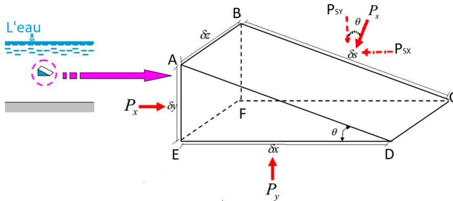
**Figure 2.1:** Notion de pression en un point d'un fluide (Loi de Pascal)
