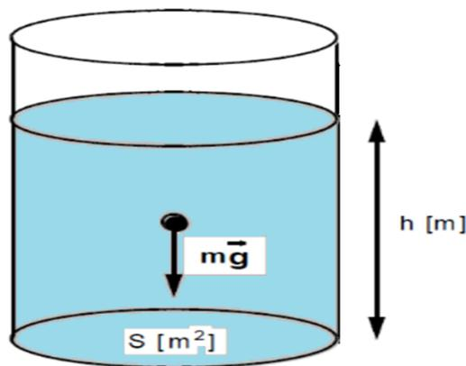
**Figure 2.2:** Le fluide et L'équilibre mécanique dans le champ de pesanteur
