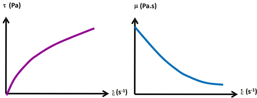
Figure 1.11: Courbe de viscosité dynamique d'un fluide non newtonien.
