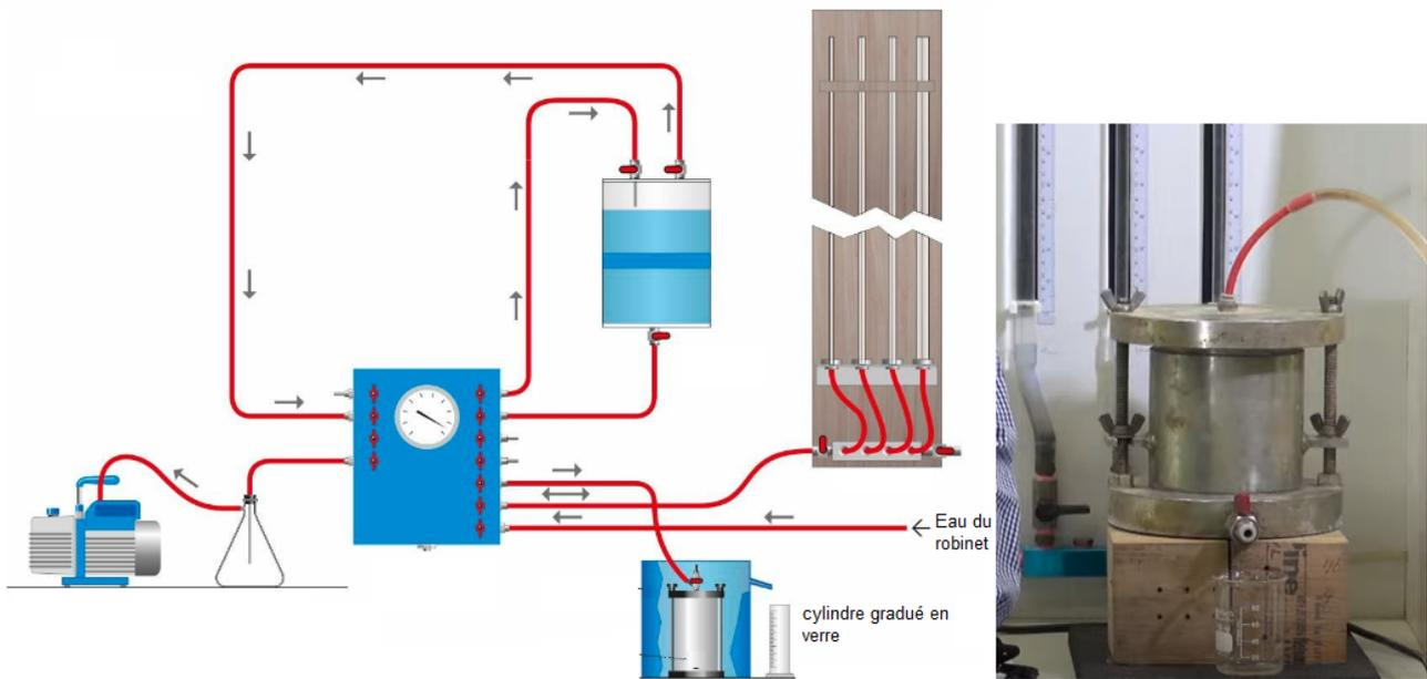
Figure 4.4: Le perméamètre à charge variable.
