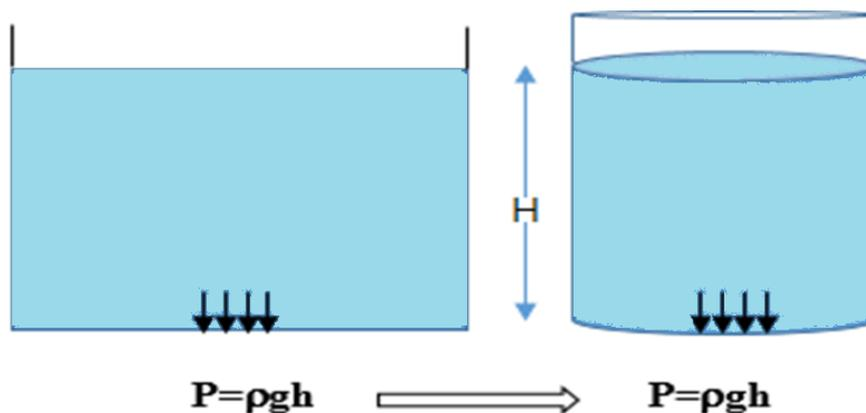
**Figure 2.3:** La pression exercée par un liquide incompressible
