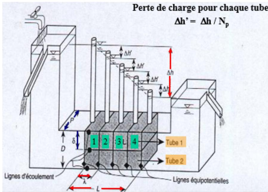
**Figure 4.15:** Débit d'infiltration (Unidimensionnel)
