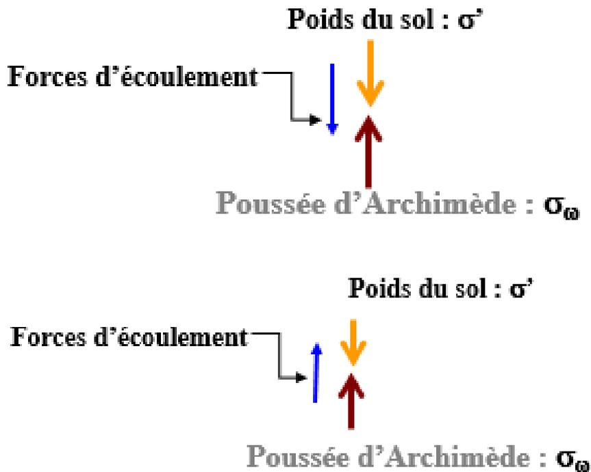
**Figure 4.11:** Les forces d'infiltration et la Boullance
