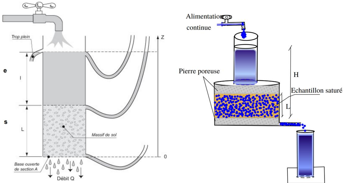
Figure 4.5: Principe du perméamètre à charge constante.
