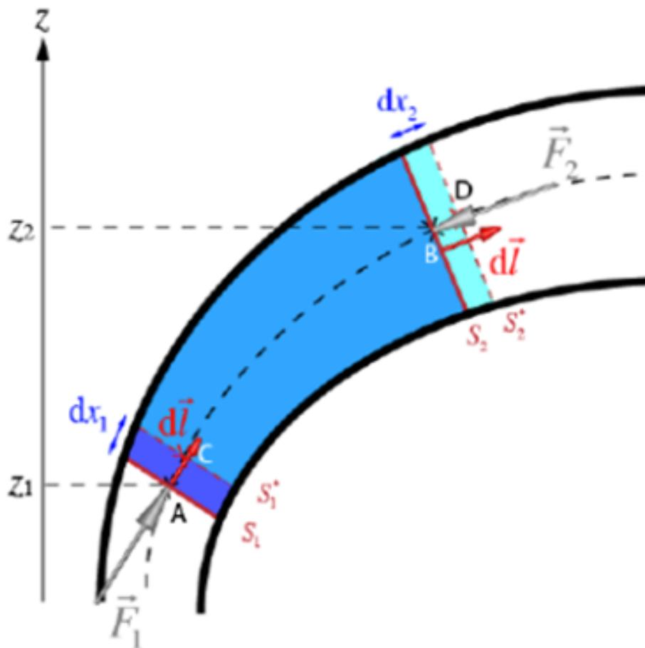
**Figure 3.6:** Travail de la force de pression et la conservation de l'énergie mécanique lors de l'écoulement
