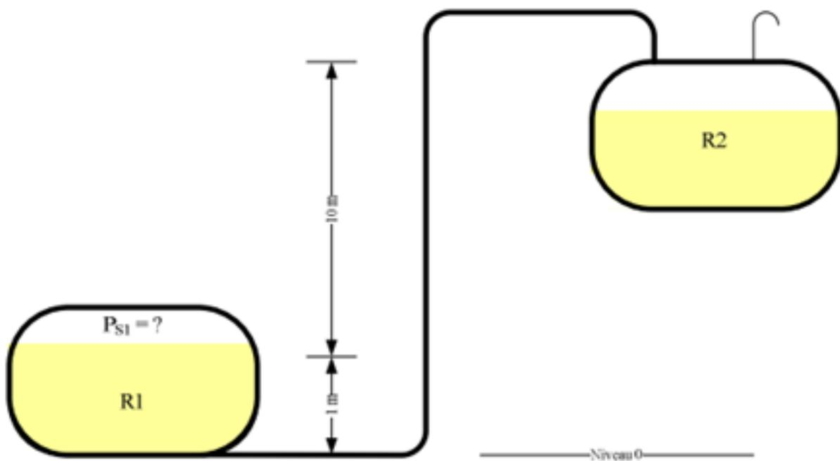
**Figure 3.9:** L'écoulement entre deux réservoirs
