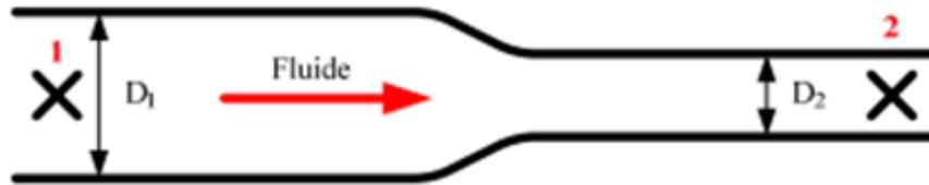
**Figure 3.8:** une canalisation circulaire et horizontale de diamètres  $D_1 = 56$  mm et  $D_2 = 38$  mm
