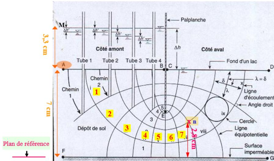
Figure 4.21: Calculs des charges hydrauliques  $h_A$  et  $h_N$
