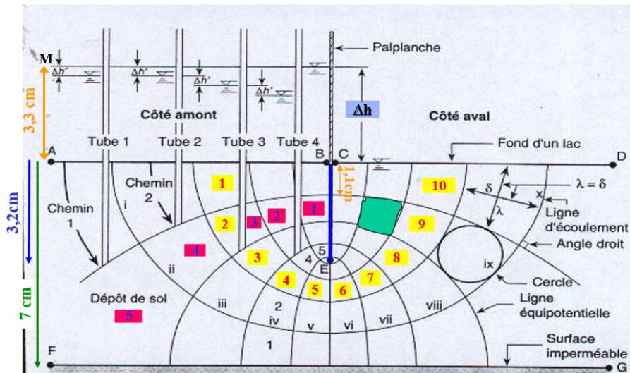
Figure 4.20: Déterminer :  $h_A, h_H, Q$  et  $F_s$
