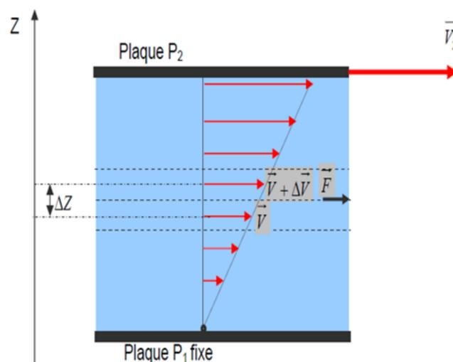
Figure 1.12: La résistance au glissement entre deux couches séparées par un liquide
