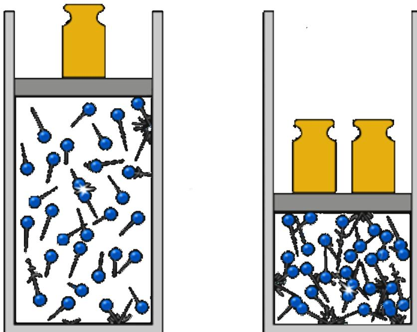
Figure 2.5: Pression de gaz (La pression double et le volume est divisé par 2... le produit PV reste constant)
