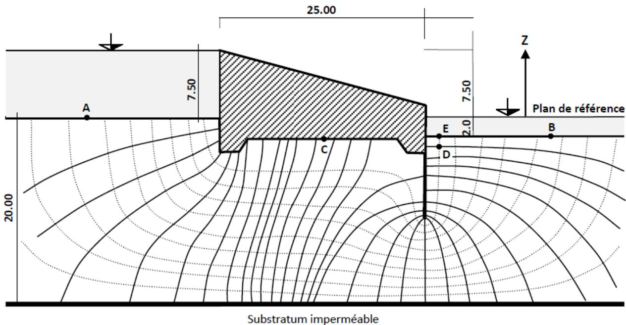
**Figure 4.26:** Un barrage fondé sur une couche d'alluvions perméables
