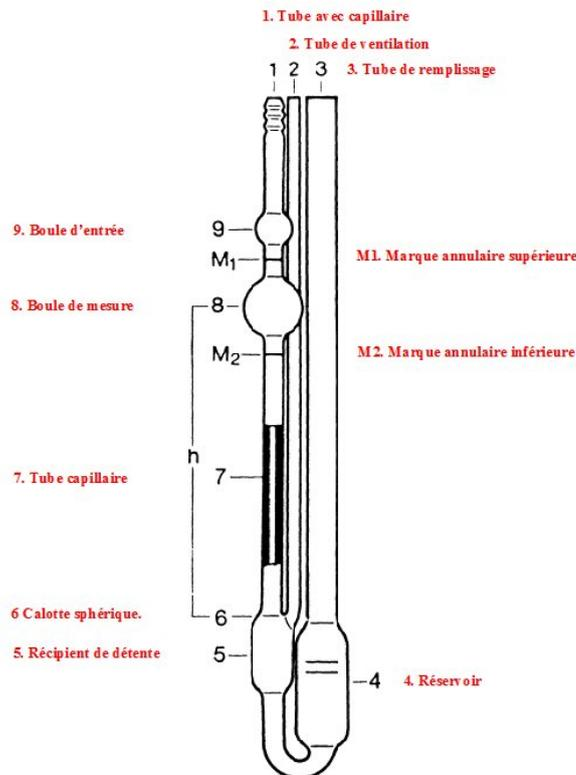
**Figure 1.13:** La méthode le viscosimètre à capillaire
