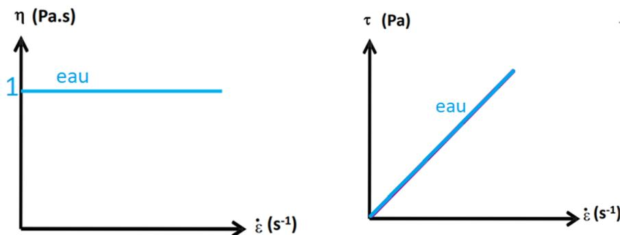
**Figure 1.10:** Rhéogrammes et courbe de viscosité dynamique d'un fluide newtonien.
