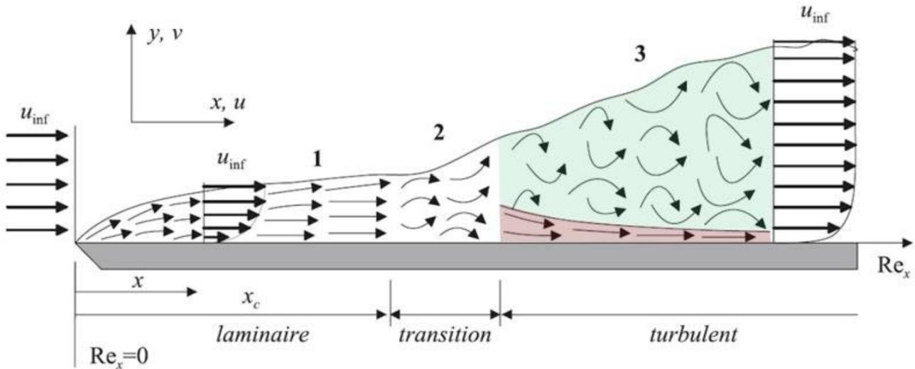
Figure 1.6: Régimes d'écoulement
