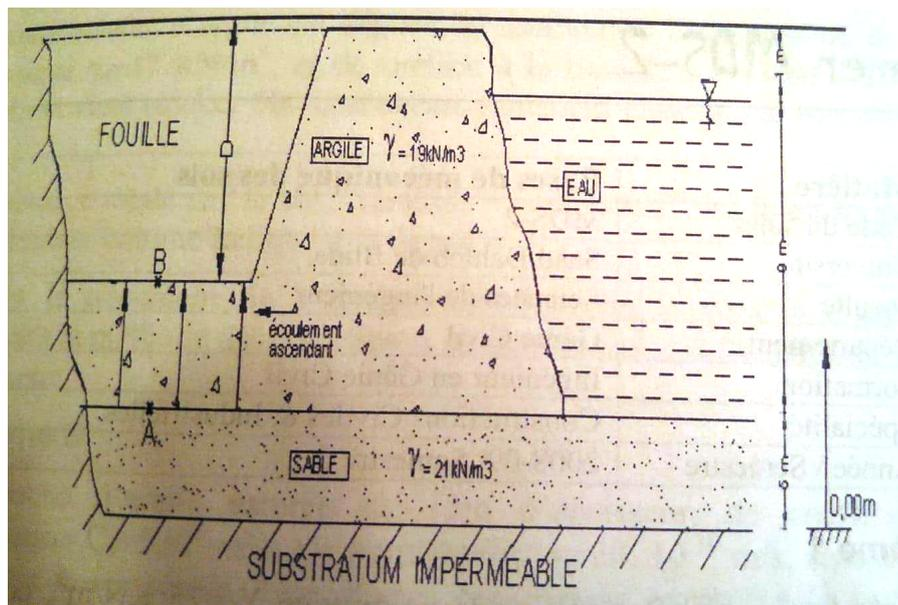
Figure 4.22: profil en long de la fouille
