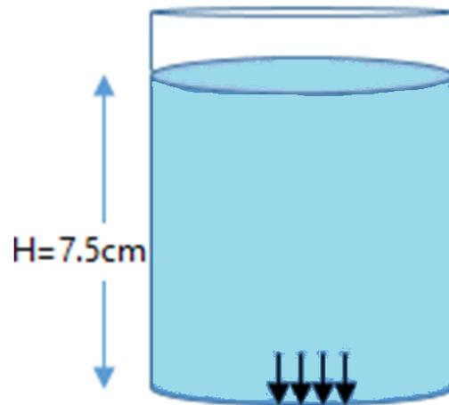
**Figure 2.12:** Un récipient cylindrique de 100 [cm<sup>2</sup>] de section
