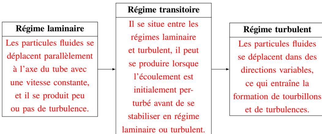
1. **Le régime laminaire;** Ce régime est observé dans des liquides très visqueux, à de très faibles vitesses ou dans des tubes capillaires (l'écoulement d'huile dans un tube capillaire). ce qui peut être décrit par l'équation de Poiseuille :
