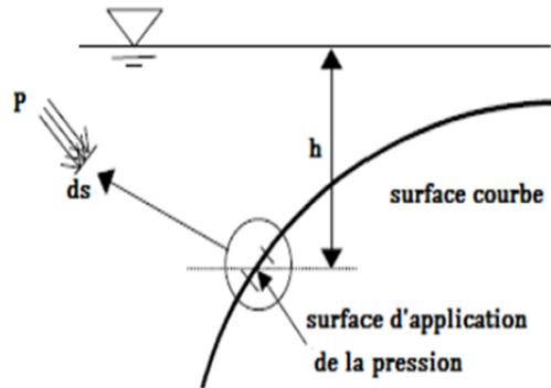
**Figure 2.9:** La composante normale, qui représente la force de poussée hydrostatique
