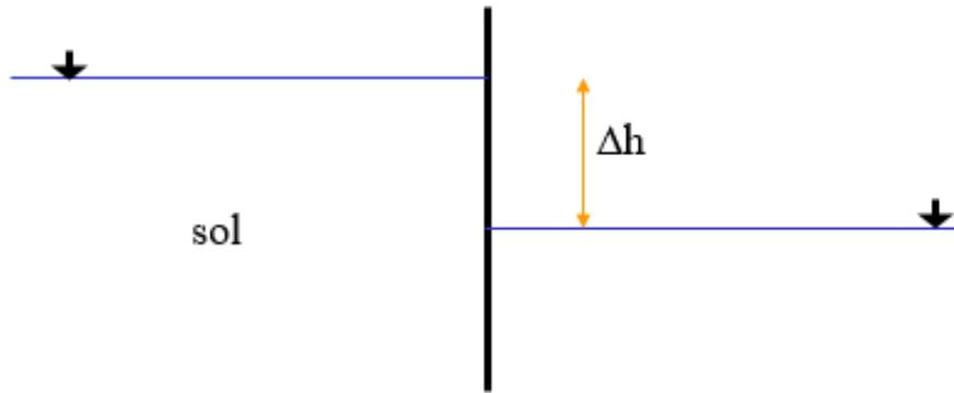
Figure 4.14: La diminution la perte de charge (rabattement de la nappe)
