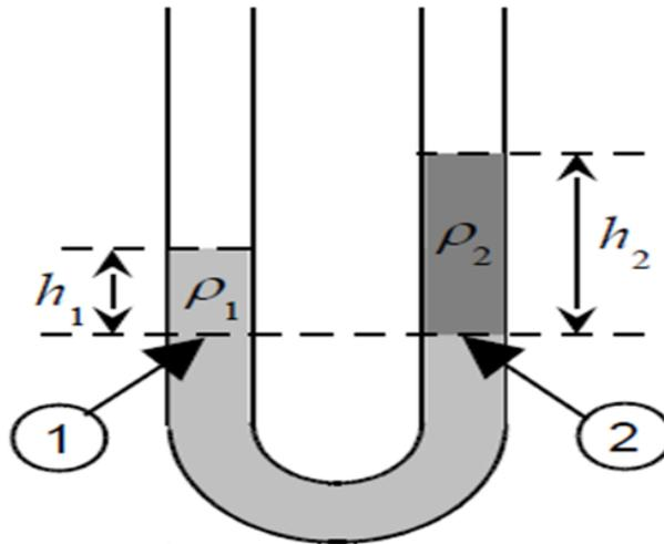
**Figure 2.11:** un tube en U rempli avec deux liquides non miscibles
