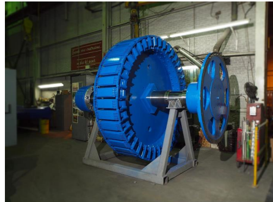
Figure. IV.10.b Rotor à pole saillant
