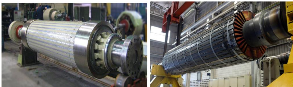
Figure. IV.10.a Rotor à pole lisse (cylindrique)
