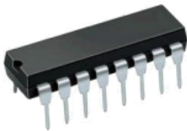
Figure I.27: un circuit intégré des années 80 dans son "pack" en céramique (Dual In Line) prévu pour l'insérer sur des circuits imprimés.
