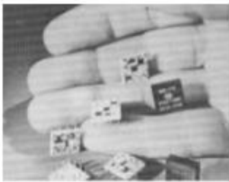
Figure I.25: au centre, une micro-plaquette ou puce et, autour, les composants qu'elle remplace.
