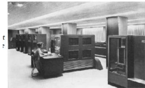
Figure I.23: L'IBM 704 fut conçu par Gene Amdahl et possédait une mémoire centrale à tores de ferrite
