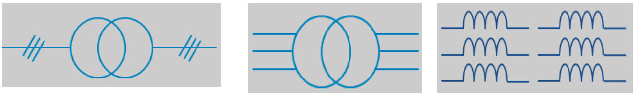
Fig 11 : symbole du transformateur triphasé
