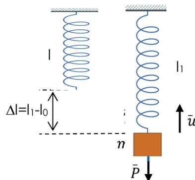
Figure 48 : Ressort à vide, puis avec une masse attachée à son extrémité.
