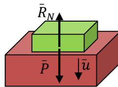
**Figure 49** : Force de réaction d'un support.
