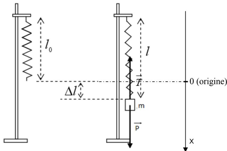
**Figure 24** : Mouvement d'une masse attachée à un ressort.
