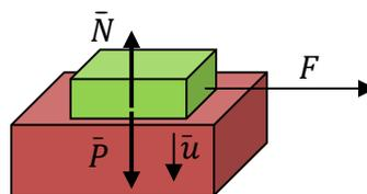
**Figure 50** : Force de frottement exercée par un support sur un objet muni d'une force motrice.
