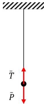
Figure 47 : Tension d'un fil.
