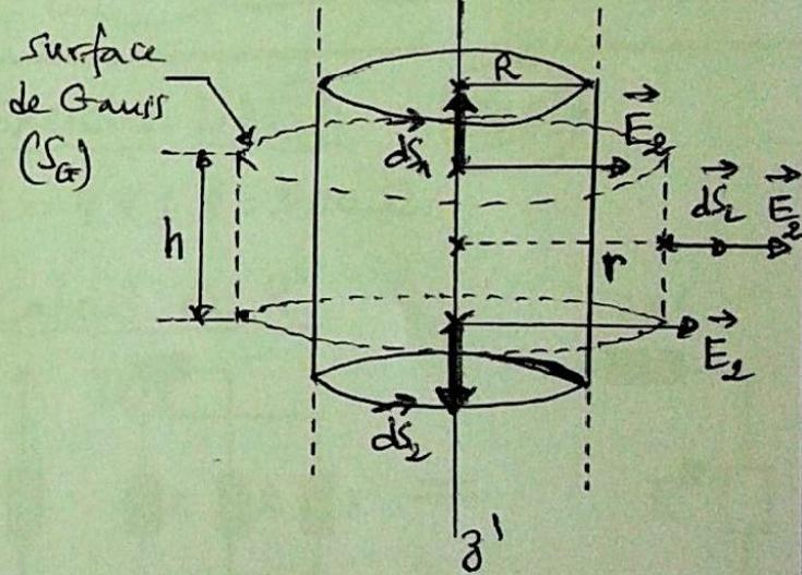
• la charge intérieure à  $S_G$  est celle portée par la surface du cylindre  $(R, h)$  incluse à l'intérieur de  $S_G$ , elle s'écrit:
