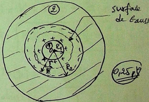
les armatures (1) et (2) sont portées aux potentiels respectifs  $V_1$  et  $V_2$ , les charges sont  $+Q$  et  $-Q$ .
