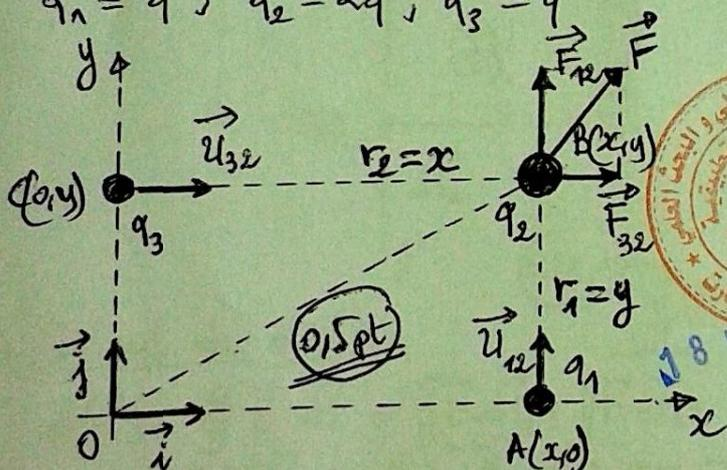
1/- la résultante des forces  $\vec{F}$  est la somme vectorielle des deux forces  $\vec{F}_{12}$  (exercée par  $q_1$  sur  $q_2$ ) et  $\vec{F}_{32}$  (exercée par  $q_3$  sur  $q_2$ ):
